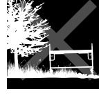
INSTALE EL ANDAMIO SOBRE UNA SUPERFICIE FIRME, PLANA Y A NIVEL
