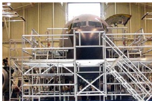
Échafaudages d'accès mobiles
